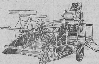
De 1,47 metros de corte para tractores desde 25 HP. Perfecta limpieza de grano. Máquinas en funcionamiento en España 500 unidades.
