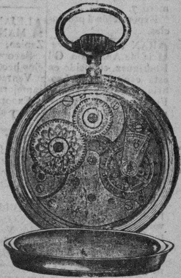
OMEGA.—Reloj fijo, de áncora, línea recta, levés visibles, doble platillo, espiral, Breguet y volante compensado.
