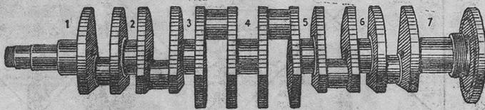
De una sola pieza tomada de la masa, perfectamente equilibrado, rectificado, provisto de 7 grandes coginets
