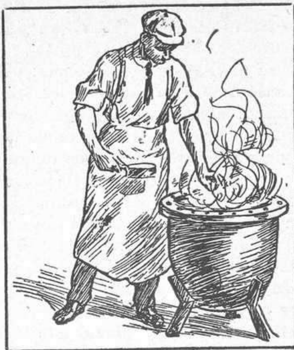
La caldera donde se bañan los alfileres para que se pongan blancos.
