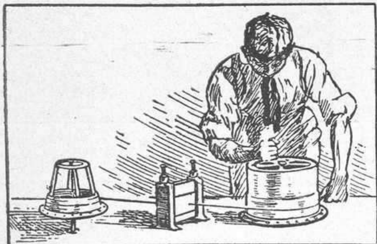
Estirando y suavizando el alambre para hacer los alfileres.
