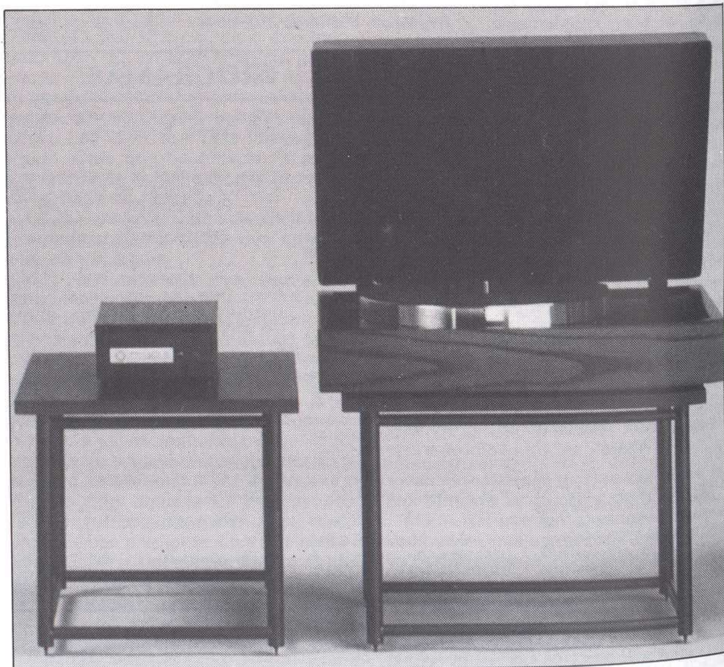
El soporte para tocadiscos más utilizado es el de tipo rígido pero ligero.
