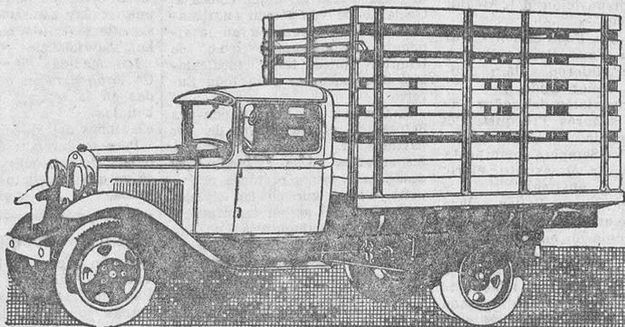
85 Kms. por hora con carga normal. - 4 velocidades. Pistones de aluminio. - Más de 20 cojinetes. - Más de 40 clases de acero. - Ballestas traseras Cantilever de 16 hojas. - Cristal inastillable. Nuevo precio más reducido.
