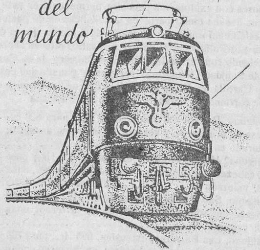
de un rendimiento de 8000 HP. fué construida por SIEMENS SCHUCKERTWERKE A G de Berlin para el servicio de trenes rápidos de los ferrocarriles alemanes del Reich
