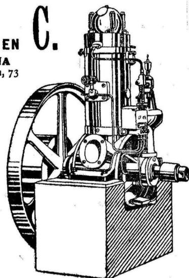
Motor para aceites pesados, sin válvulas, sin mecanismo adecuado para trilladoras.
