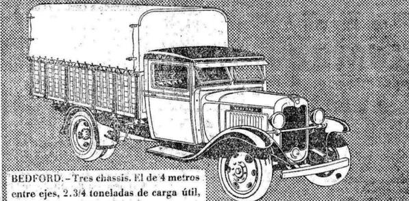
BEDFORD.—Tres chasis. El de 4 metros entre ejes, 2.3/4 toneladas de carga útil, puente trasero flotante, ruedas gemelas. Ptas. 11.800
