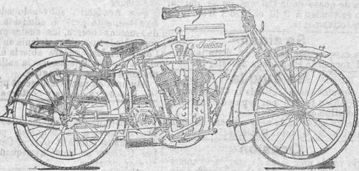
Dos cilindros con 7 HP nominales. Cuadro montado en masiles. Tres velocidades y embrague de discos secos múltiple. Carburador automático con chorro auxiliar para baja velocidad. Ruedas grandes (28 X 3), propias para estas carreteras.
