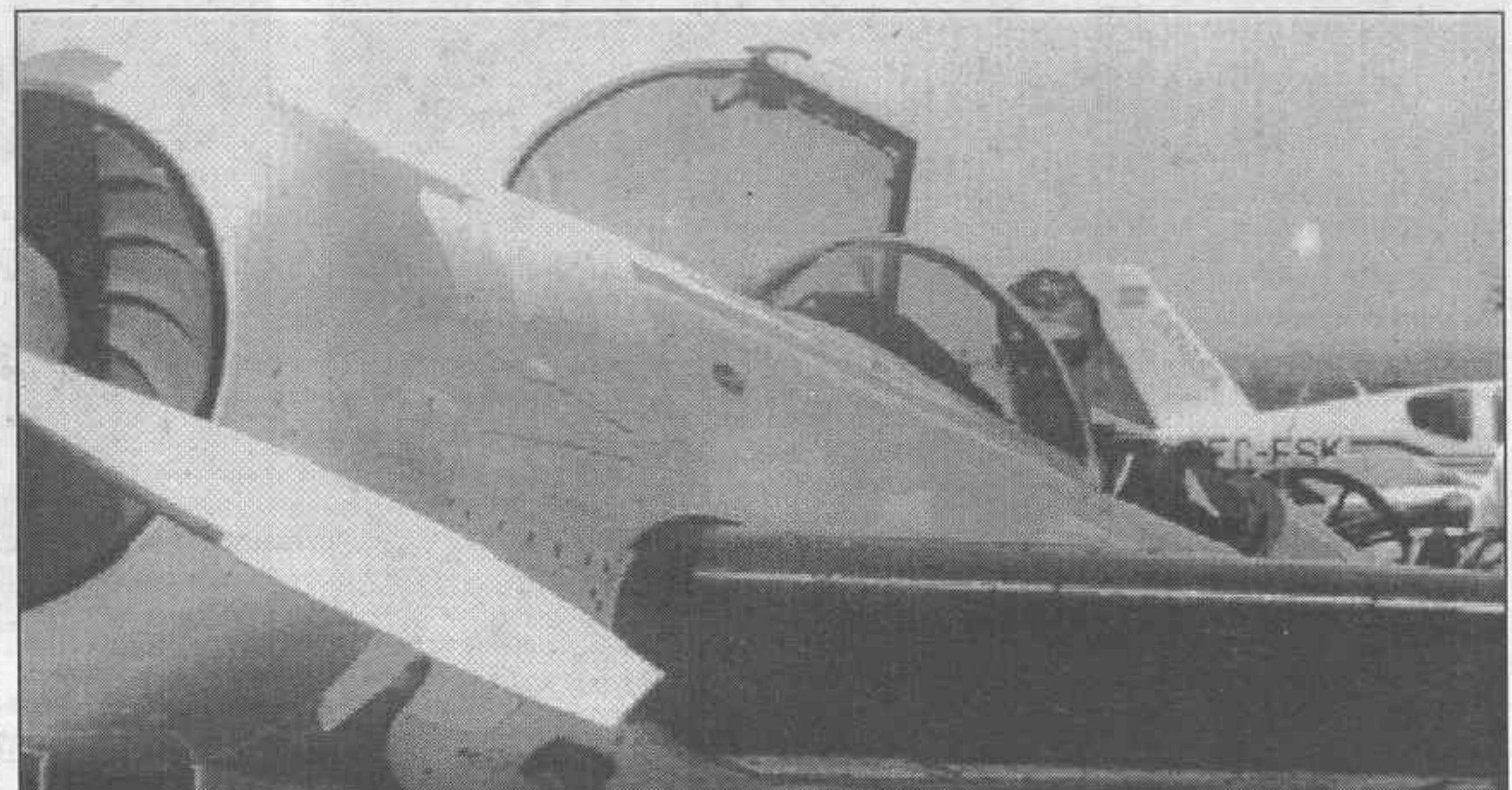
SUKOI 31: Avión especialmente diseñado para la aviación deportiva y más concretamente para la acrobacia aérea. Es el avión que normalmente pilota el campeón de España Ramón Alonso. Alcanza los 500 km/h, soporta los 12 G tanto en positivo como en negativo y tiene una ratio de giro de 420 grados por segundo.
