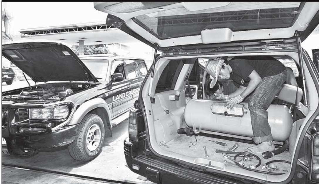
Alternativas a la gasolina. Mientras el crudo sigue su marcha imparable, en algunos lugares del planeta se empiezan a tomar medidas. Como en Tailandia, donde abundan los jeeps americanos y coches de lujo que consumen gran cantidad de carburante. En la imagen, un trabajador tailandés instala un tanque de gas licuado del petróleo (LPG) en un coche en un garaje de Bangkok. El propietario del garaje, Sirichai Siradapuvadol, afirmó que ya ha instalado más de 400 tanques de LPG en turismos este año y que tiene encargos solicitados hasta el próximo mes de octubre. / FOTO: EFE
