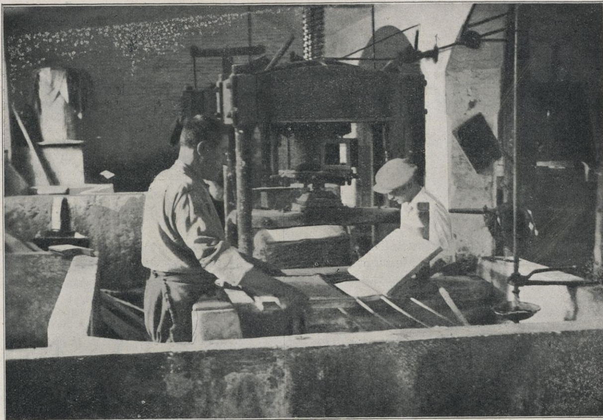
Una «Tina» (depósito de pasta en estado acuoso) para la elaboración del papel a mano, con el «Alabrent» que hace el Papel con el molde y el «Llevador» que saca la hoja de papel del molde colocánola encima una bayeta. Al fondo una prensa a mano para escurrir el agua del papel.
