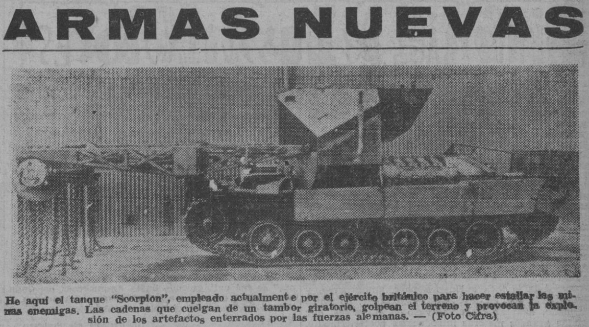
He aquí el tanque "Scorpion", empleado actualmente por el ejército británico para hacer estallar las minas enemigas. Las cadenas que cargan de un tambor giratorio, golpean el terreno y provocan la explosión de los artefactos, enterrados por las fuerzas alemanas. — (Foto Cifra)
