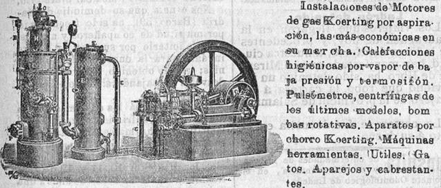
Instalaciones de Motores de gas Koerting por aspiración, las más económicas en su marcha. Calefacciones higiénicas por vapor de baja presión y termosifón. Pulsómetros, centrífugas de los últimos modelos, bombas rotativas. Aparatos por chorro Koerting. Máquinas herramientas. Útiles. Gatos. Aparejos y cabrestantes.
