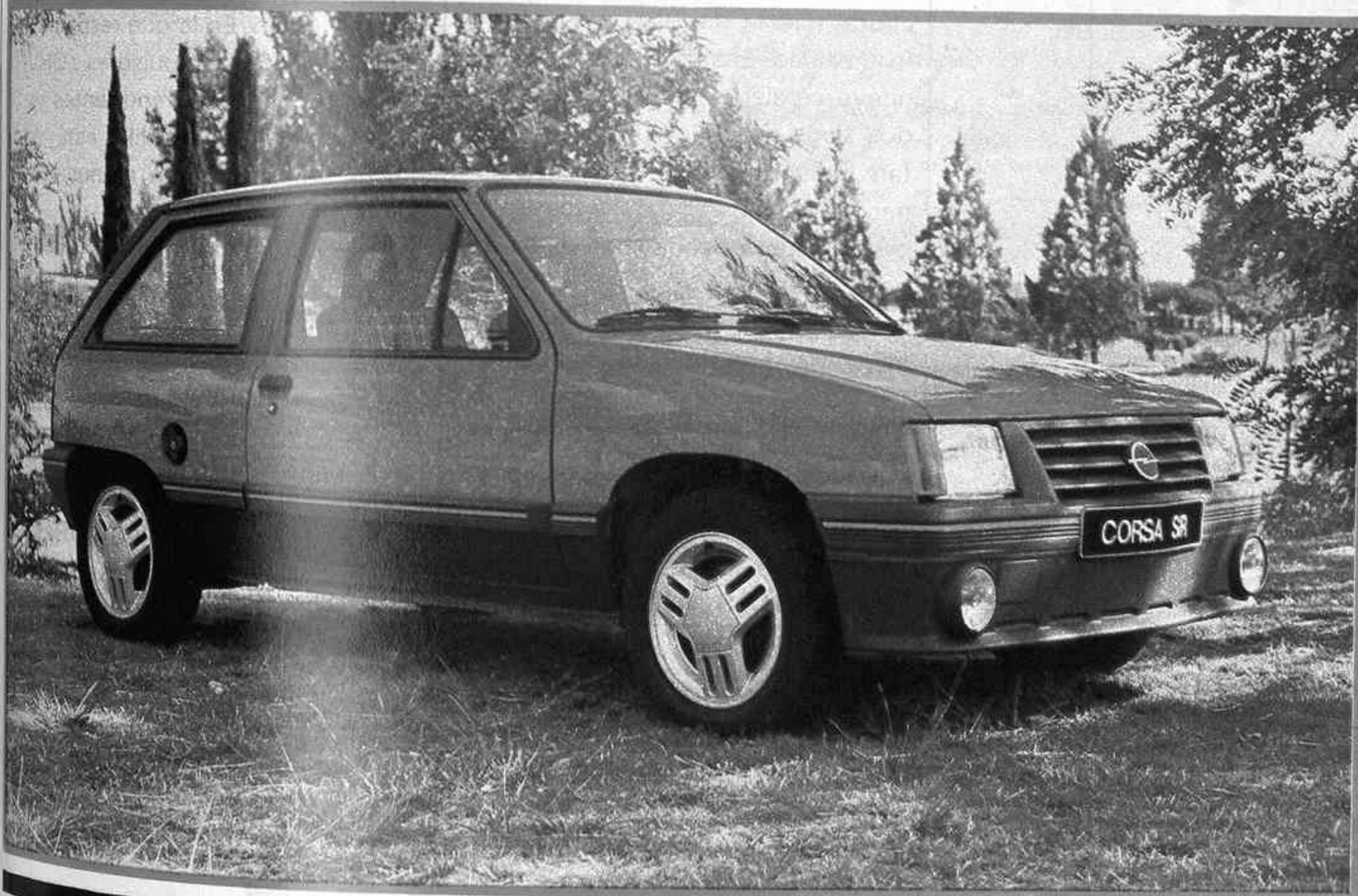
Nueva versión deportiva Opel Corsa SR, que equipa el motor de 1,3 litros, con 70 CV. de potencia.
