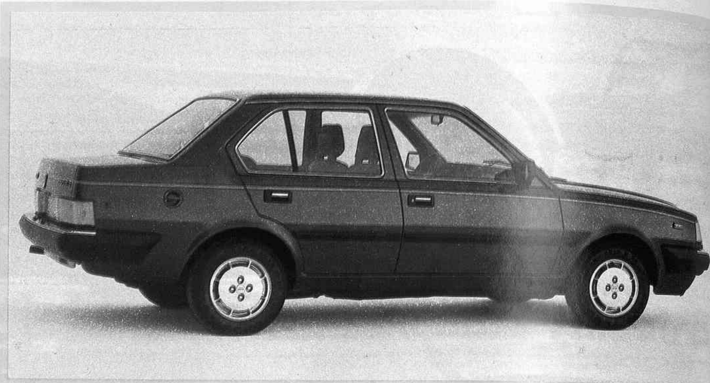
Nueva línea de carrocería en la Serie-3 de Volvo, ahora con el modelo 360 GLE, que monta el motor de 115 CV. de potencia y a su vez el sistema de inyección LE-Jetronic.
