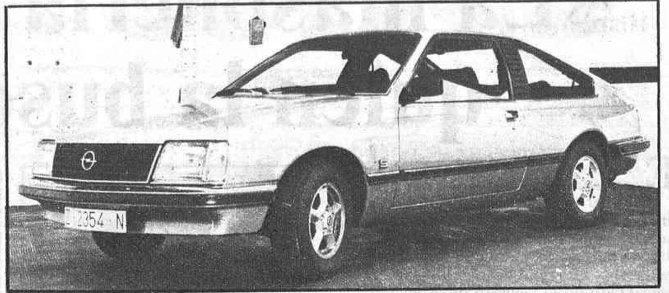
Modelo Monza coupé 2 puertas, 3 litros, cuyo motor de 6 cilindros le proporciona una potencia de 132 CV. DIN, que le dan una velocidad máxima de 215 Kms/h.
