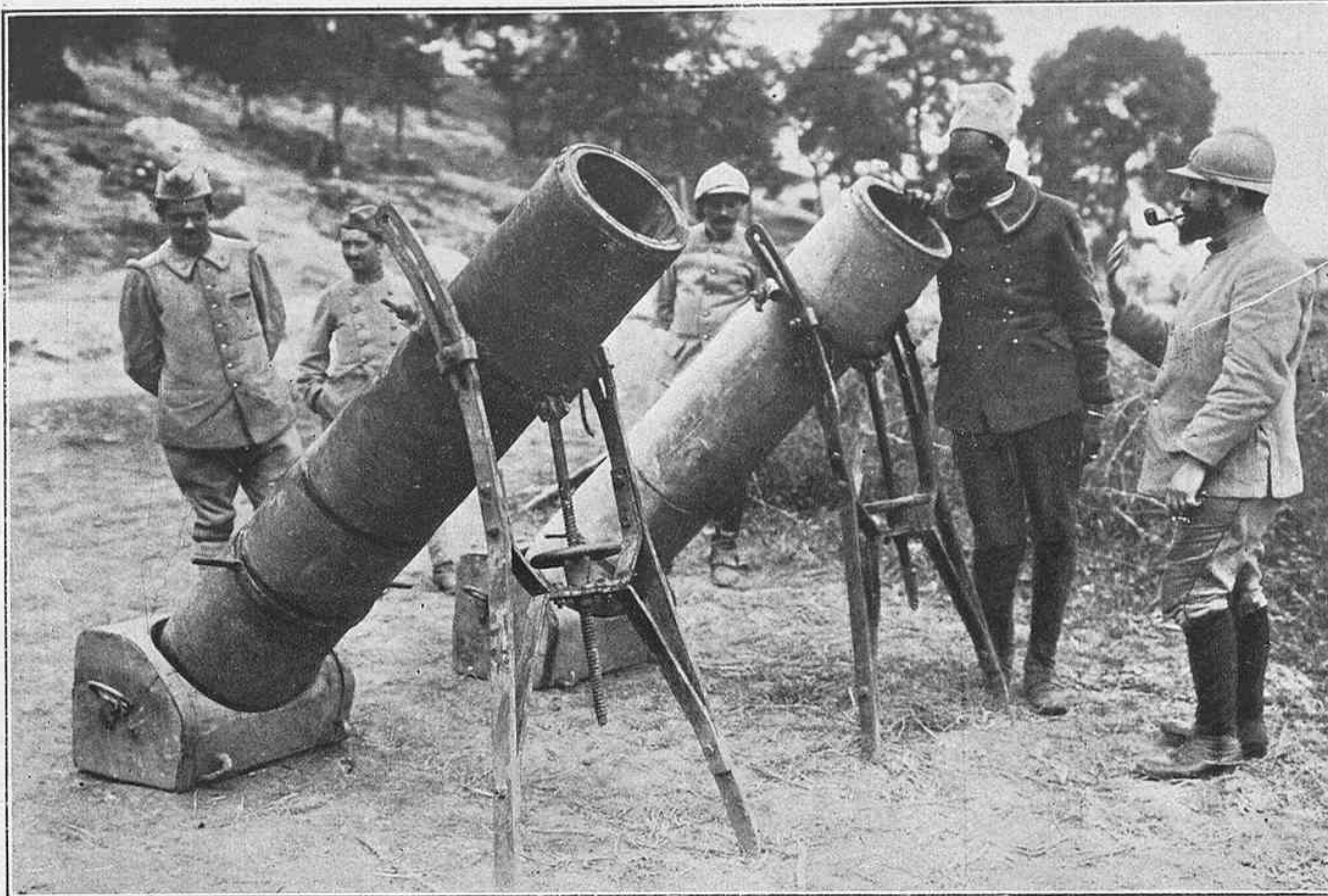
Cañones de trinchera cogidos por los franceses a los alemanes en el Somme. Estos cañones son de madera, tienen 257 milímetros de diámetro y 1,35 metros de alto y lanzan proyectiles de 1,30 metros de largo.
