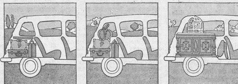
La capacidad es una de las grandes ventajas del Renault 4. Un maletero de suelo plano, sin obstáculos para la carga, que ofrece tres alternativas de uso: normal (295 dm<sup>3</sup>), con bandeja plegada (para llevar objetos altos), y con el asiento trasero abatido (1.185 dm<sup>3</sup>).
