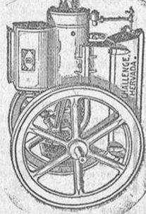
Los motores CHALLENGE forman un solo cuerpo con los depósitos y se refrescan con unos diez litros de agua.
