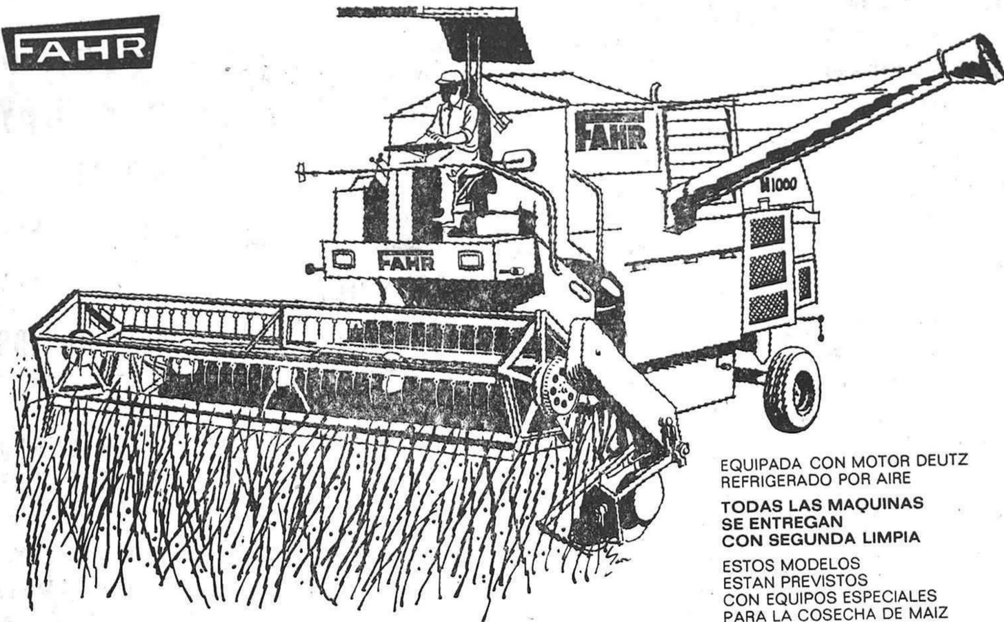
EQUIPADA CON MOTOR DEUTZ REFRIGERADO POR AIRE
