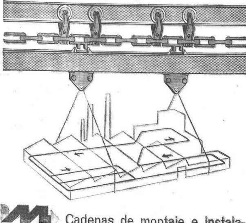
Cadenas de montaje e instalaciones para automatización del transporte.
