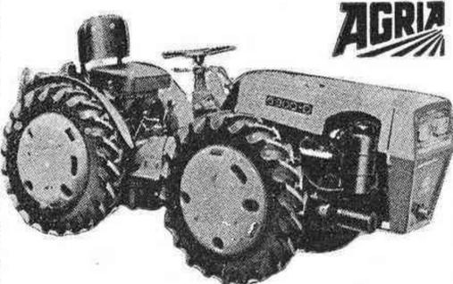
10 HP. a GAS-OIL. CONSTRUÍDO ESPECIALMENTE PARA NARANJOS. ALTURA: 58 cm. 6 VELOCIDADES. 2 VELOCIDADES PARA CAVADORA Y ROTAVATOR. PRECIO F.F. MAQUINA CON RUEDAS 400-8 Y ROTAVATOR: 59.500 PESETAS. SOLICITE INFORMACION O PRUEBA SIN COMPROMISO, a
