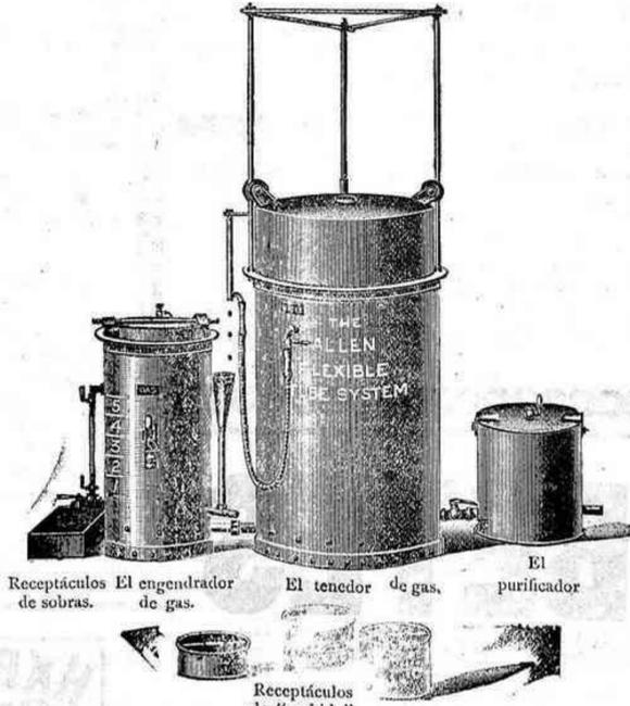
Receptáculos de sobras. El engendrador de gas. El tencedor de gas, purificador. Receptáculos de "carbido"
