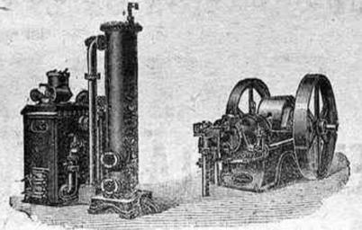
Motor y Gasógeno (Gas pobre)
