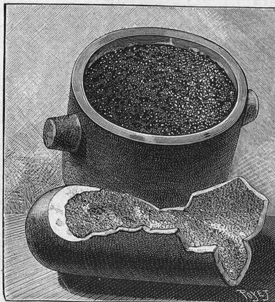
Fig. 1 Crisoles tapizados de rubíes artificiales
