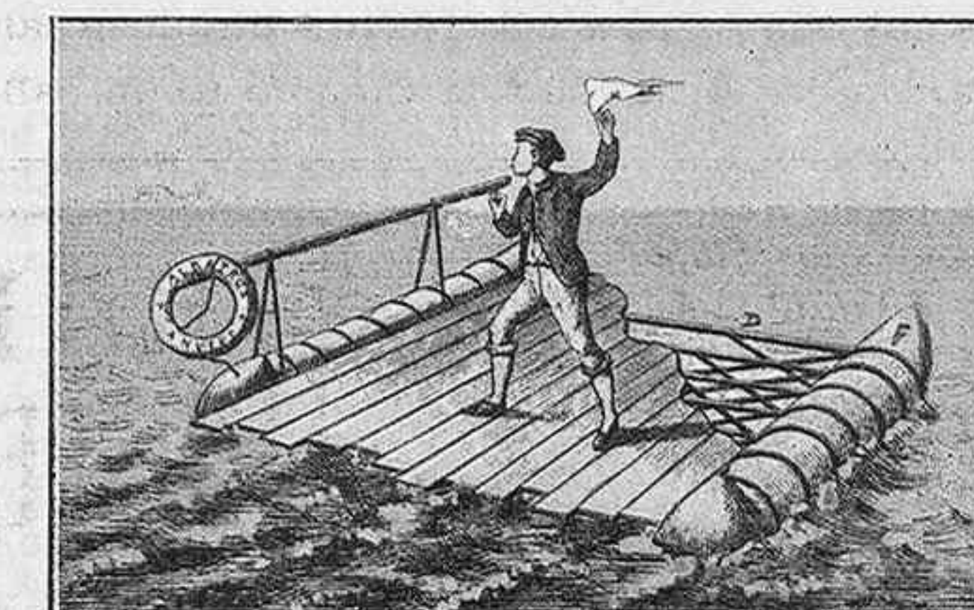
Fig. 4. - Balsa sostenida por flotadores de acetileno
