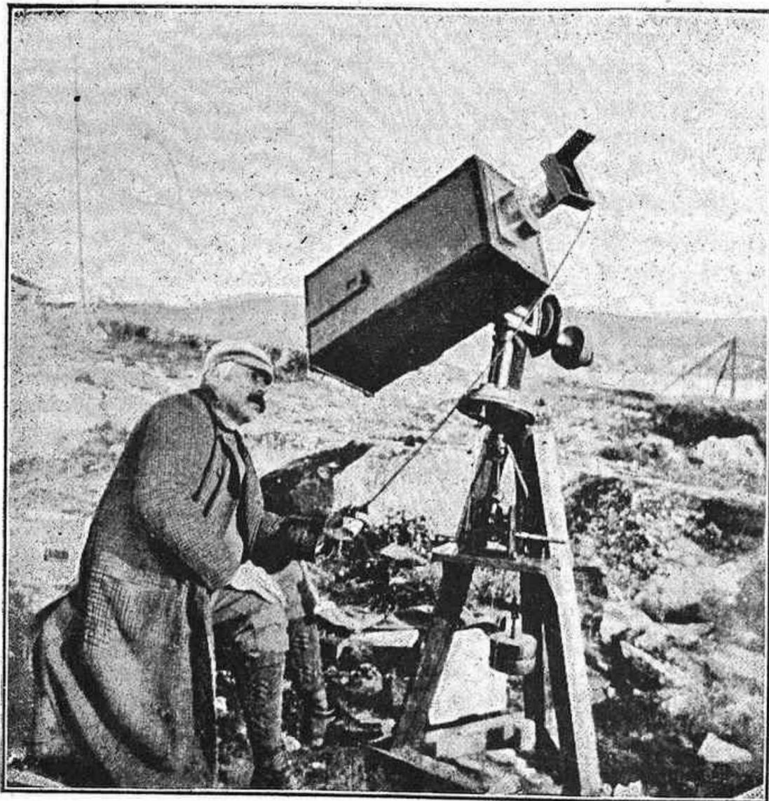
fera celeste un círculo paralelo al Ecuador. Y si un aparato de relojería ó de otro arte, comunicase al eje una rotación conveniente, entonces el instrumento montado sobre él seguiría automáticamente al astro enfilado; ese es el ideal, pero no es accesible á todos, aunque con ingenio suficiente cada uno puede hacer mucho, conociendo las condiciones esenciales á que debe satisfacer.
