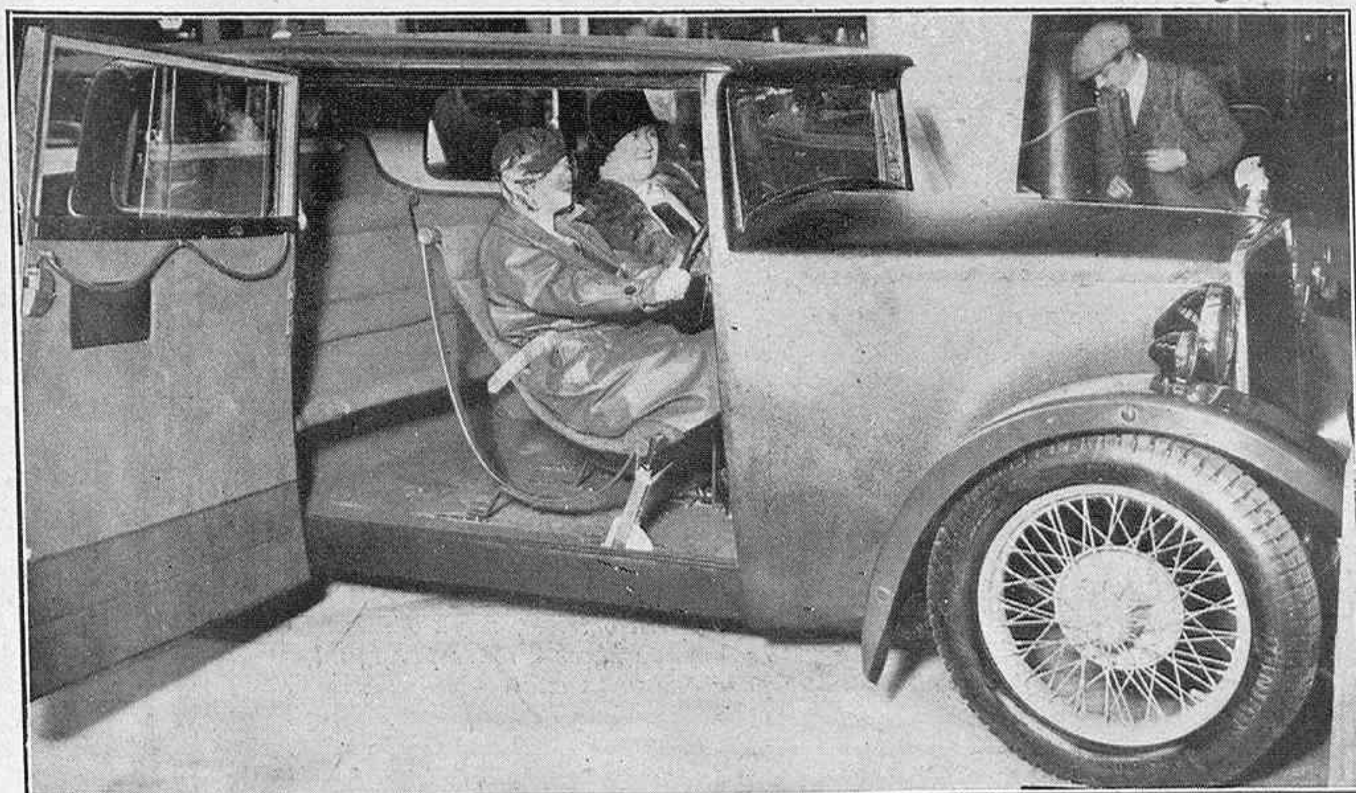
Algunos modelos han substituído el antiestético baúl ó maleta posterior por un amplio depósito de capacidad superior. En nuestra fotografía, el cristal que substituye á la pared del coche permite apreciar la capacidad
