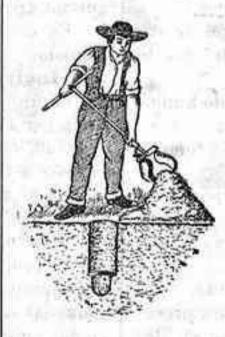
Arados JANUS; Gradas de MUELLES, ZIG-ZAG y ROTATIVAS; Cultivadores AMERICANOS; TRITURADORES de grano; Trillos ROTATIVOS de gran trabajo; HILO DE ABACÁ; MOTORES A GASO-LINA «NEW-WAY» enfriados por aire; BARRENAS PARA TIERRA, hacen hoyos de 20 á 25 centimetros de diámetro y hasta 10 metros de profundidad, propias para plantación, pozos, etc.
