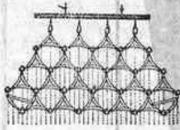
Esta Grada de 2 metros de ancho, con 60 puas y un peso de unos 25 kilos, provista de balancín, puede con toda facilidad ser tirada por una sola caballería. Es un aparato predilecto para gradear sementeras nacidas, pues hace un trabajo perfecto sin arrancar una sola planta y una labor muy económica por su ancho de trabajo. Vale sólo pesetas 65.
