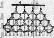
Esta Grada de 2 metros de ancho, con 60 puss y un peso de unos 25 kilos, provista de balancín, puede con toda facilidad ser tirada por una sola caballería. Es un aparato predilecto para gradear sementeras nacidas, pues hace un trabajo perfecto sin arrancar una sola planta y una labor muy económica por su ancho de trabajo. Vale sólo pesetas 65.
