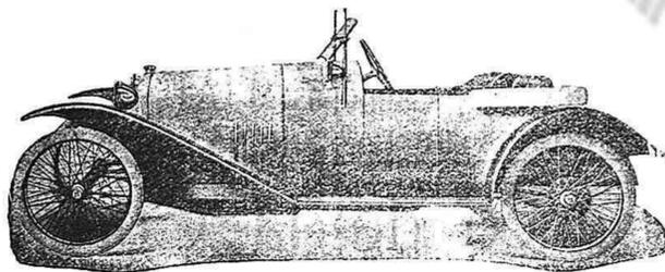
MODELOS 7 Y 10 HP.—CUATRO CILINDROS PARA DOS. TRES Y CUATRO ASIENTOS
