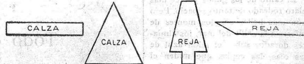
RECORTES Y PLETINAS PARA FABRICACIÓN DE HERRADURAS.
