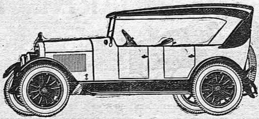
El más moderno, perfecto y económico.—MOTOR seis cilindros 40 HP. Aviación.—Engrase perfecto y moderno a presión.—Válvulas en cabeza con mandos engrasados a presión.—Freno hidráulico a presión de aceite en las cuatro ruedas.—Cubiertas BALLON.—Carrocería la más fina y elegante. Pruebas, catálogos y detalles:
