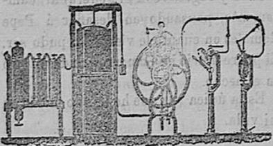
Aparatos para hacer gaseosas, continuo con embotelladora en columnas independientes.
