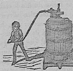
Prensa Hércules, para uvas sistema de palanca múltiple reforzada.
