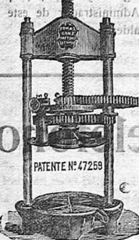
Sistema de prensa a palanca, de doble engrane y doble efecto, con patente de invención, estudiado y construido para sustituir las prensas hidráulicas a palanca, aventajando a éstas en PRESIÓN, en ECONOMIA y FACILIDAD en el manejo.
