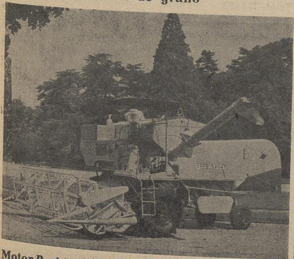
Motor Perkins, tanque de granos y ensacador lateral, segunda limpia
