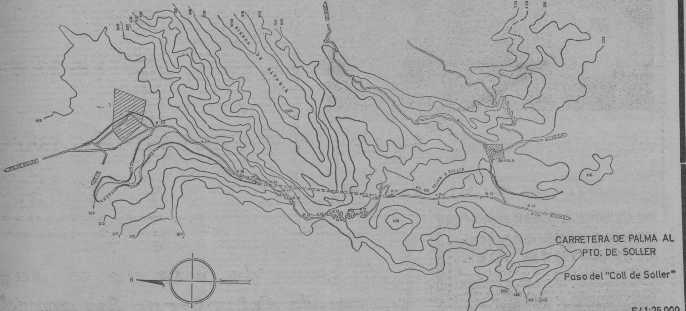
EN EL GRABADO, PUEDE ApreciARSE EL TRAYECTO QUE SIGUE LA CARRETERA, Y EL QUE CORRESPONDE A LA VIA DEL FERROCARRIL. EN EL KILOMETRO 17 COINCIDEN AMBOS CAMINOS. Y ESTE ES PRECISAMENTE EL PUNTO DONDE COMIENZA EL TUNEL. UN POCO MAS ALLA DEL KILOMETRO 27, ACABA LA EXASPERANTE SUCCESION DE CURVAS, Y DESMBOCA TAMBIEN EL REFERIDO TUNEL. EL TRAZO DE DICHO TUNEL APARECE SOBRE EL CROQUIS CON LINEAS PARALELAS PUNTEADAS. ESTE ES PRECISAMENTE EL NUDO Y LA BASE DEL PROYECTO: CONVERTIR EN DOS KILOMETROS Y OCHOCIENTOS METROS DE AUTOPISTA... LO QUE AHORA SON MAS DE DIEZ KILOMETROS DE CURVAS
