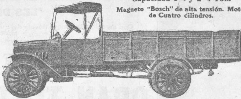
Chassis listo para aplicar la carrocería apropiada al trabajo a que se destinen. El Regulador del motor es automático y evita excesos de velocidad. Carburador provisto de entrada para aire caliente, lo que aumenta la economía de combustible y permite usar los inferiores.
