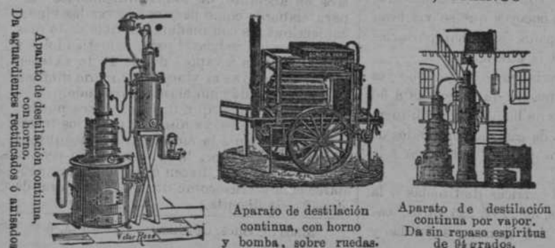
Aparato de destilación continua, con hornos, y agudientes rectificados ó ahilados. Aparato de destilación continua, con horno y bomba, sobre ruedas. Aparato de destilación continua por vapor. Da sin resaca espiritus de 84 grados.
