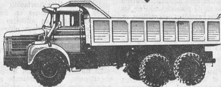
Motor diesel "MAGIC" de 240 CV. Con más de 9 cv. por Tn. Tara + carga 26 Tn. Distancia entre 1<sup>er</sup> y 3<sup>er</sup> ejes: 5,20 m.
