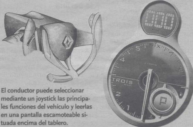
El conductor puede seleccionar mediante un joystick las principales funciones del vehículo y leerlas en una pantalla escamoteable situada encima del tablero.
