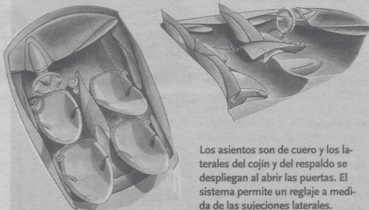
Los asientos son de cuero y los laterales del cojín y del respaldo se despliegan al abrir las puertas. El sistema permite un reglaje a medida de las sujeciones laterales.
