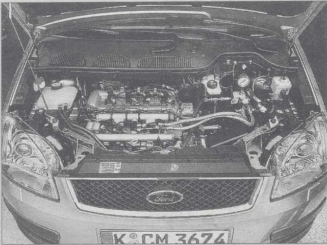
COMBUSTIBLE ALTERNATIVO. Motor de hidrógeno del C-MAX.
