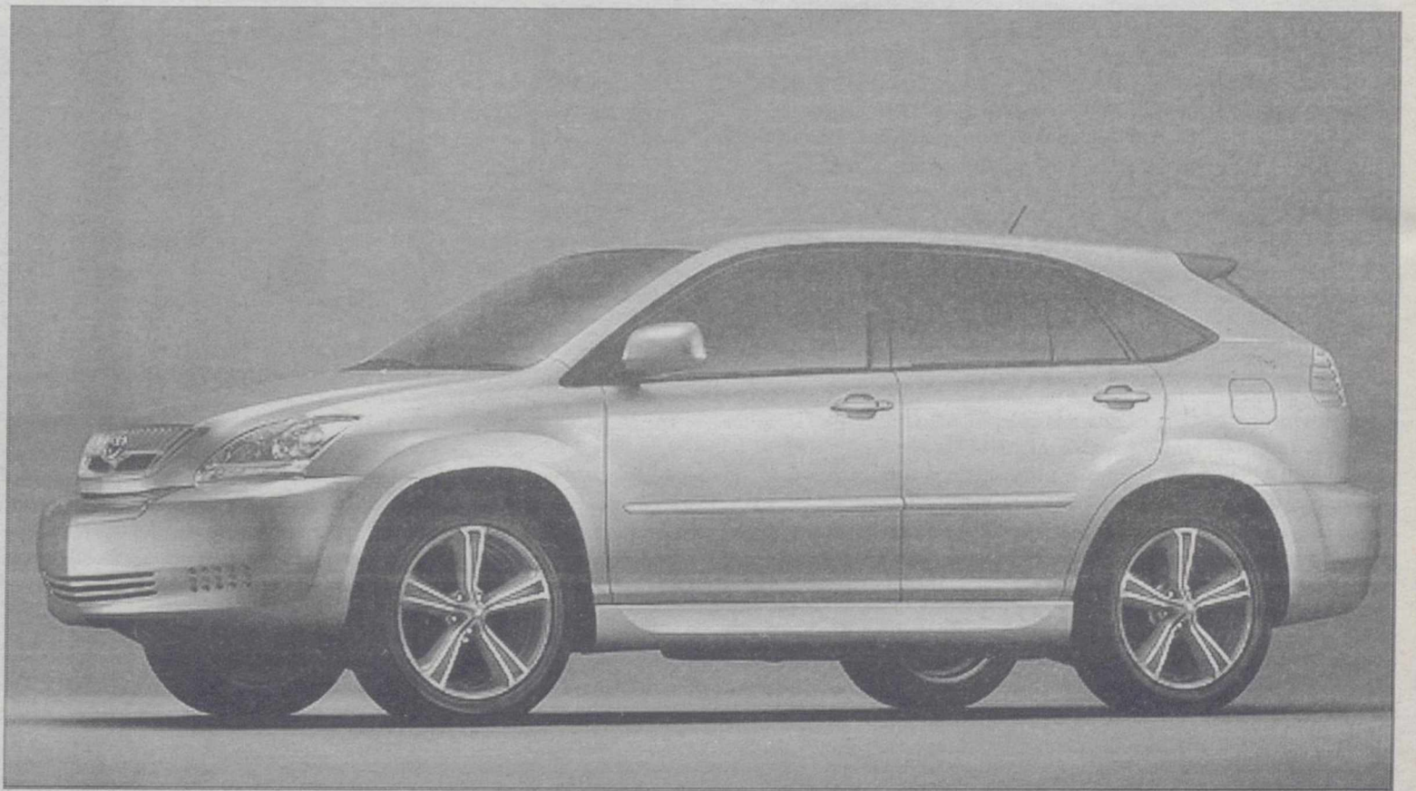
El SU-HV1 es un todocamino o todoterreno ligero híbrido con motor de gasolina V6 de 3.3 litros y eléctrico de 120 kW.
