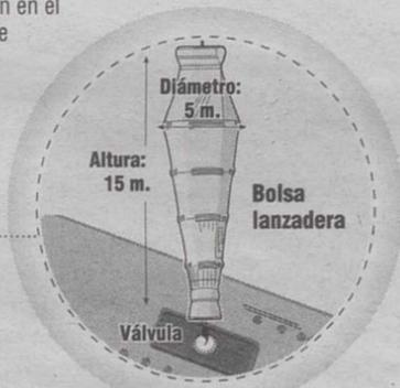
La lanzadera, construida con aluminio, puede recoger hasta 300 m<sup>3</sup> de fuel en cada descenso. Después, se elevará hasta 40 metros de profundidad, donde se acoplará una tubería flexible que trasladará el fuel al barco
