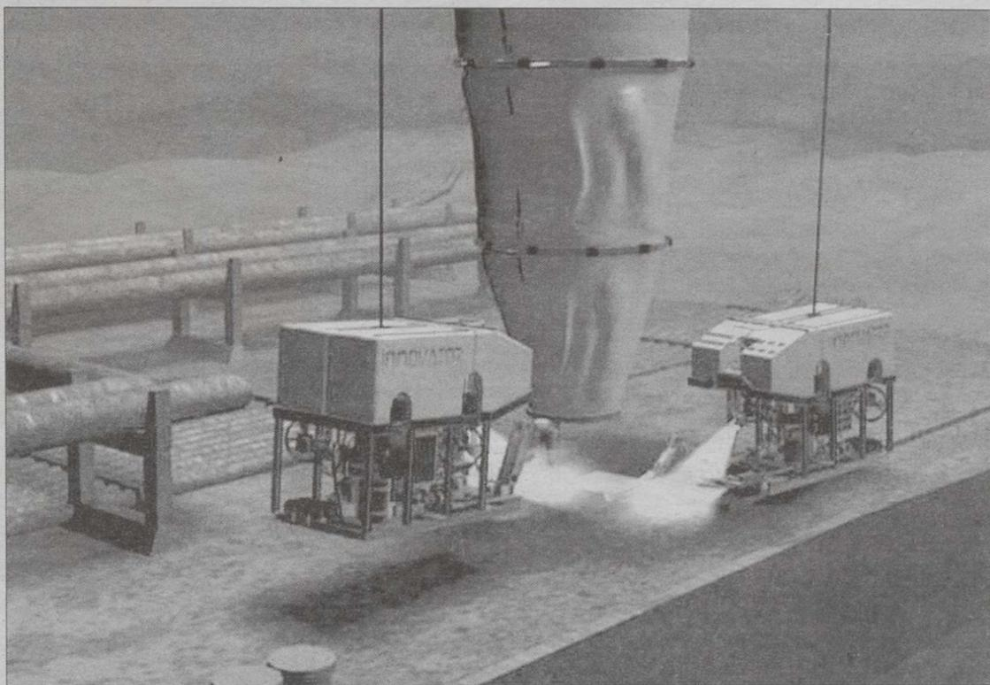
Creación infográfica que muestra los robots instalando una bolsa lanzadera sobre el pecio del 'Prestige'. / EFE-REPSOL
