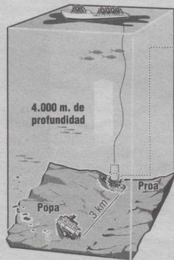
Robots abrirán orificios de 70 cm. en el casco de la proa y colocarán válvulas que dan acceso a la bolsa lanzadera, donde se almacena el combustible a medida que sale
