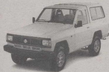
Delanteras de Ballestas Parabólicas · Diferencial Auto-blocante de Deslizamiento Limitado · Hasta 950 Kg. de Carga Útil.
