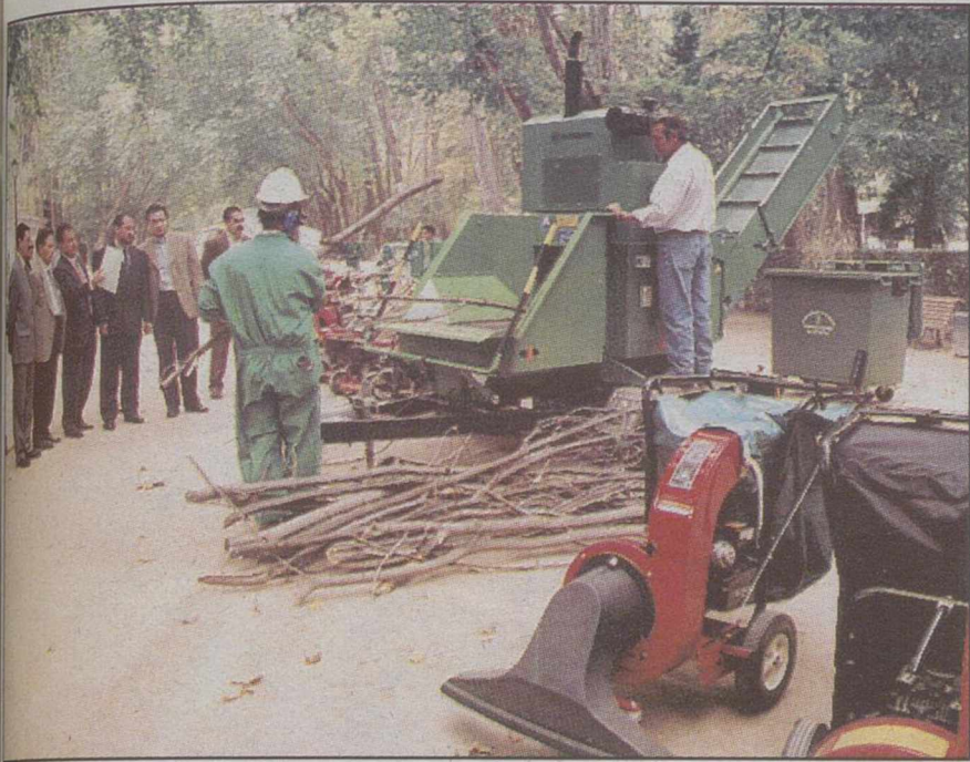
La máquina trituradora de restos de la poda permitirá fabricar compost.
