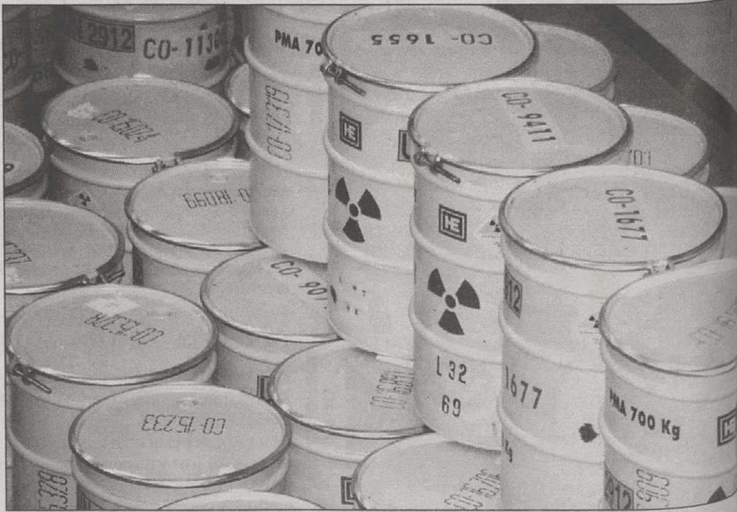
Los bidones industriales que se utilizan para este transporte son de los del tipo industrial o petrolero.
