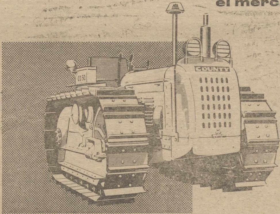
Equipado con el motor DIESEL 52 HP. del FORDSON SUPER MAJOR
